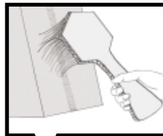
**Проведите механическую очистку контролируемой поверхности**
