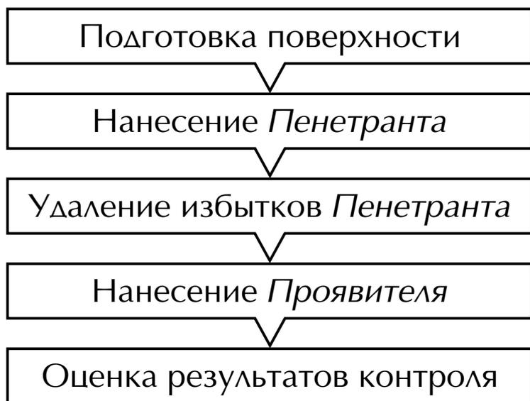
Наибольшее влияние на качество контроля оказывают две операции: удаление избытков *Пенетранта* и нанесение *Проявителя*. В данном руководстве подробно описываются технологический процесс, а также временной и температурный режимы.
